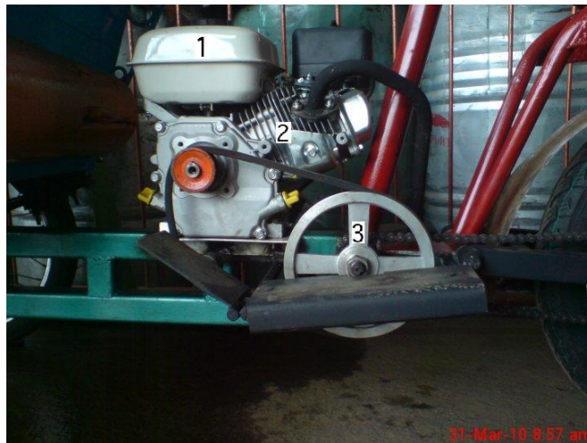
Gambar 3, Mekanisme transmisi pada becak bermesin
